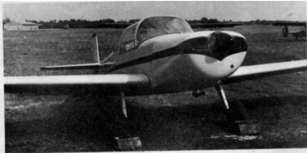
Vue 3/4 avant du F-BBIZ au point fixe. Notez sur le capot moteur, devant le pare-brise, la jauge d'essence qui disparaîtra par la suite à l'intérieur de la cabine.
