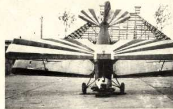
Printemps 1939, le RD-1 tout équipé : noter la simplicité du haubanage : deux mâts et des câbles tendus en X entre chaque aile. La décoration à bandes rayonnantes rouge et blanche n'est pas sans rappeler les bêtes de soigneur de Marcel Doré.
