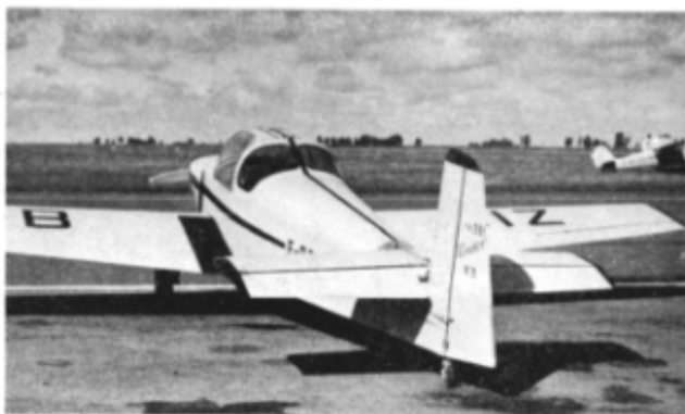
F-BBIZ, le Condor n° 3, un D-61 encore démuné de l'arête dorsale devant la dérive qui équipera ceux construits par la suite.
